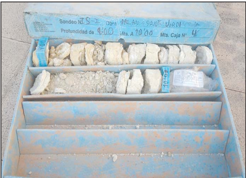
Fotografia 5. Material recuperat en el sondeig S-2 entre les cotes de -9.00 a -10.00 metres de profunditat.
