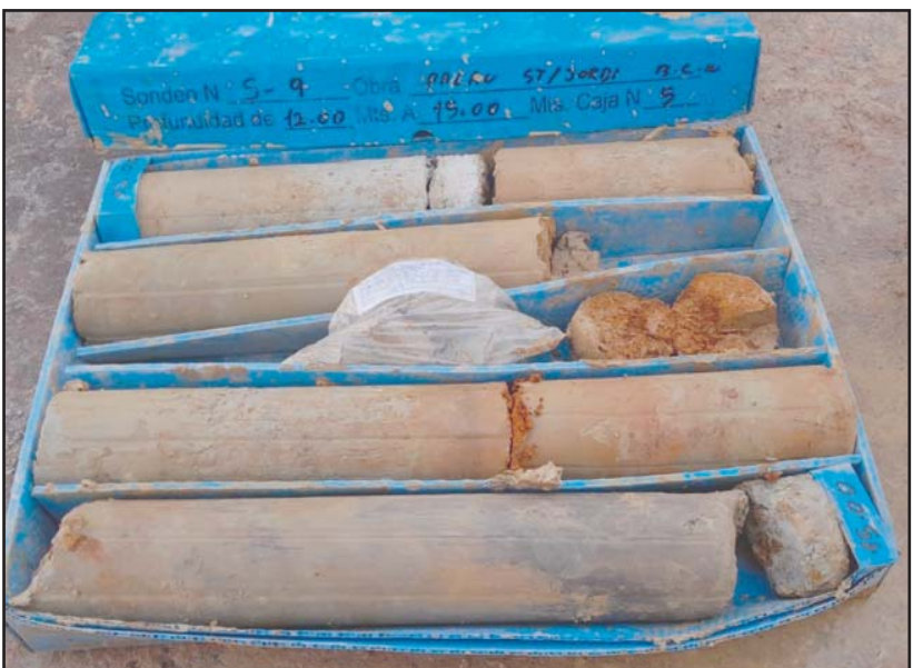
Fotografia 5. Material recuperat en el sondeig S-9 entre les cotes de -12.0 a -15.0 metres de profunditat.
