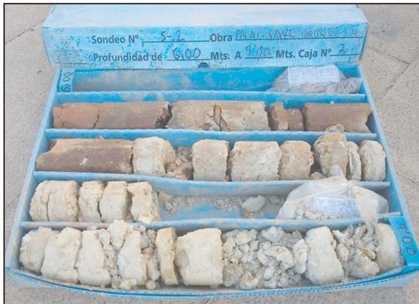
Fotografia 4. Material recuperat en el sondeig S-2 entre les cotes de -6.00 a -9.00 metres de profunditat.
