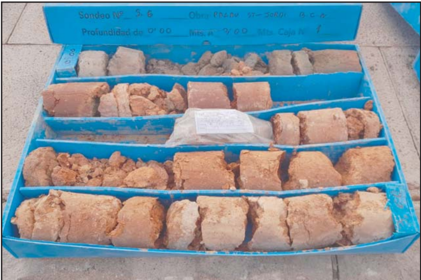
Fotografia 2. Material recuperat en el sondeig S-6 entre les cotes de 0.00 a -3.0 metres de profunditat.
