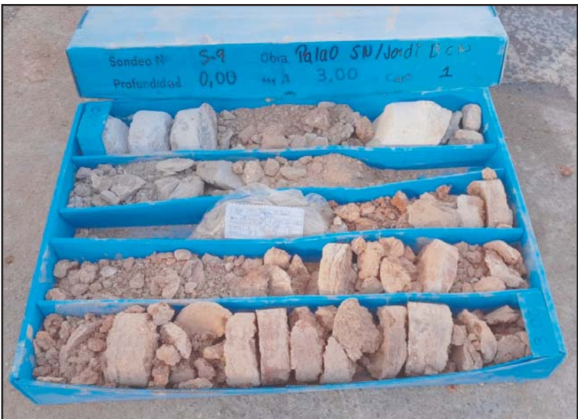
Fotografia 2. Material recuperat en el sondeig S-9 entre les cotes de 0.00 a -3.0 metres de profunditat.
