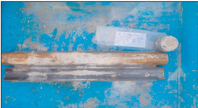
Fotografia 10. Material recuperat de l'assaig SPT-4.
