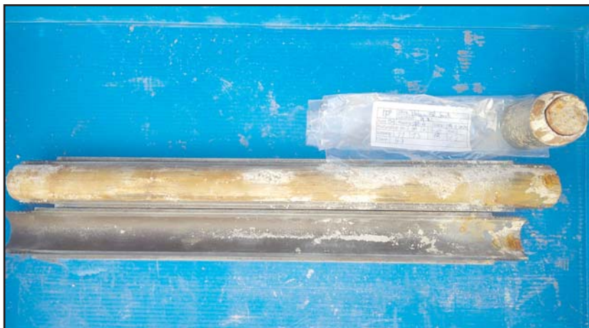
Fotografia 8. Material recuperat de l'assaig SPT-4.
