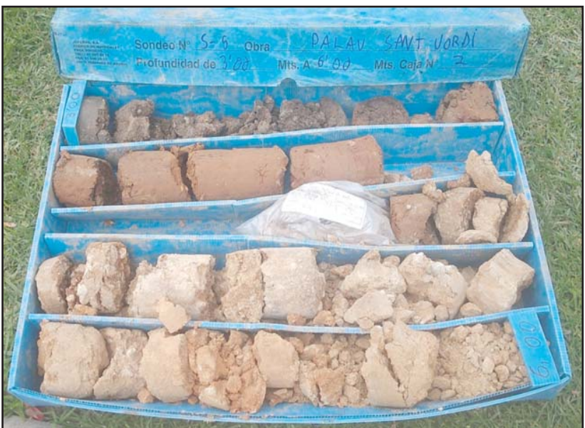
Fotografia 3. Material recuperat en el sondeig S-5 entre les cotes de -3.0 a -6.0 metres de profunditat.
