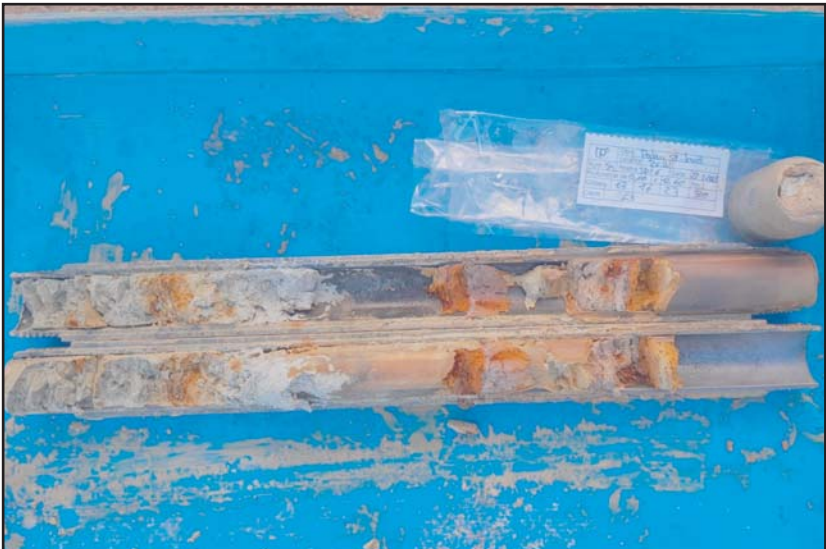
Fotografia 11. Material recuperat de l'assaig SPT-6.
