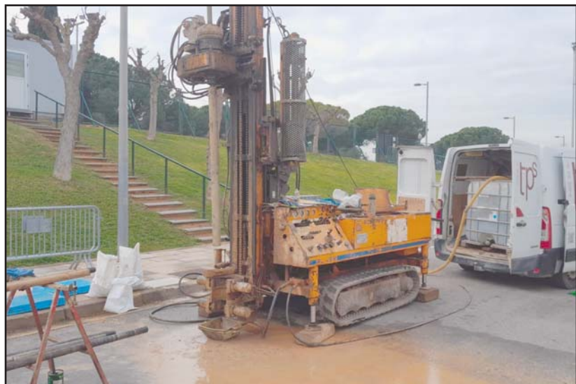
Fotografia 1. Vista de l'emplaçament de la màquina per a la realització del sondeig a rotació amb bateria continua S-7.
