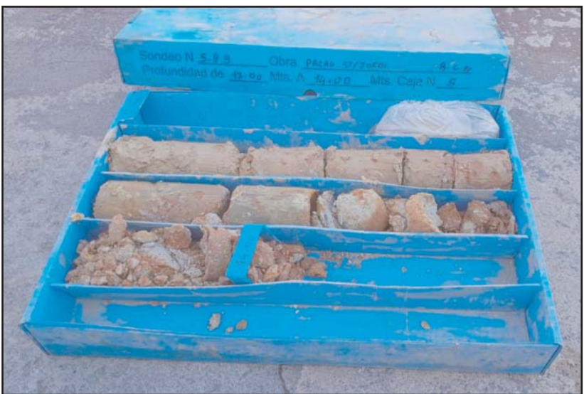
Fotografia 5. Material recuperat en el sondeig S-6 entre les cotes de -12.0 a -14.0 metres de profunditat.
