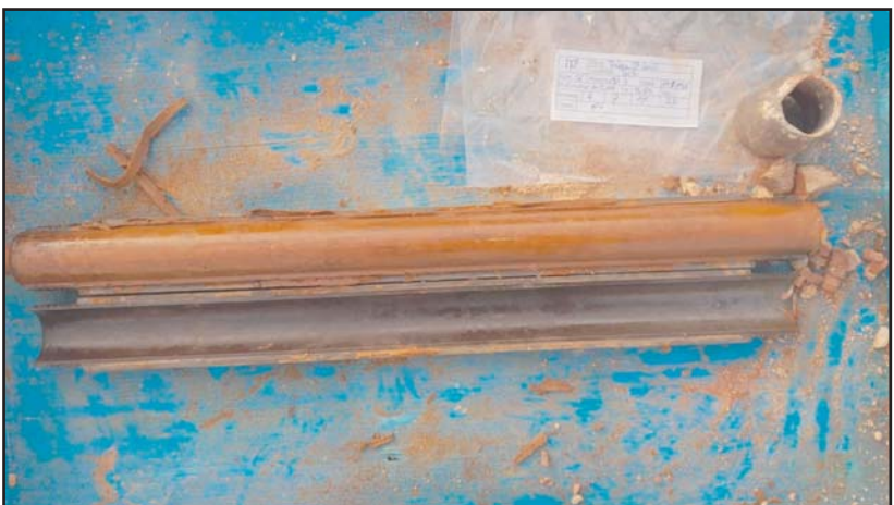
Fotografia 9. Material recuperat de l'assaig SPT-3.
