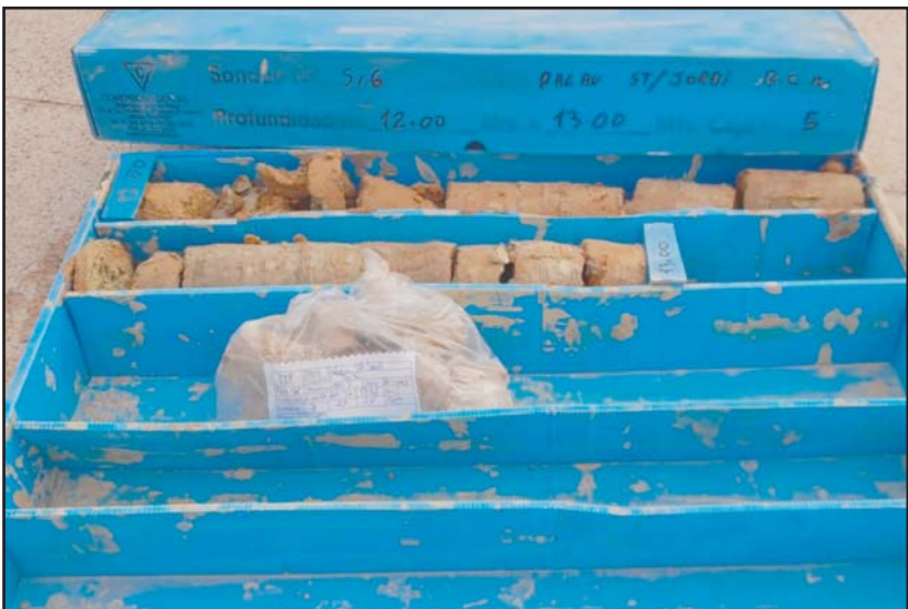
Fotografia 5. Material recuperat en el sondeig S-6 entre les cotes de -12.0 a -13.0 metres de profunditat.
