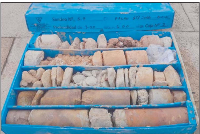
Fotografia 3. Material recuperat en el sondeig S-7 entre les cotes de -3.0 a -6.0 metres de profunditat.
