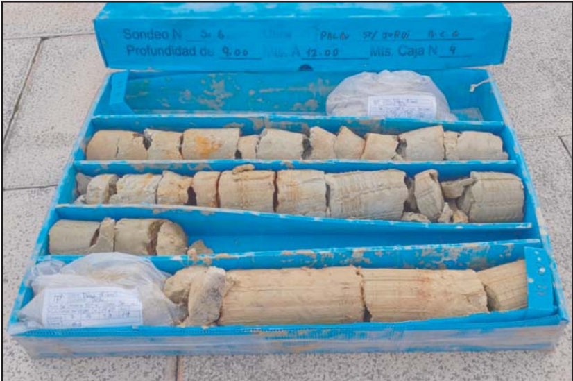
Fotografia 5. Material recuperat en el sondeig S-6 entre les cotes de -9.0 a -12.0 metres de profunditat.
