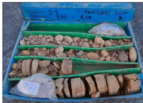
Fotografia 8 i Fotografia 9. Detall dels diferents tipus de materials del nivell 1, en dos dels sondeigs realitzats.
