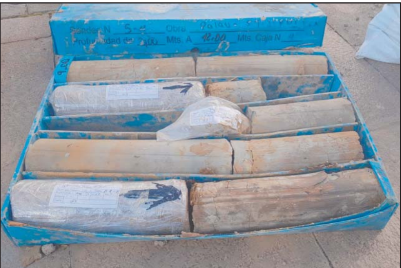
Fotografia 5. Material recuperat en el sondeig S-4 entre les cotes de -9.0 a -12.0 metres de profunditat.
