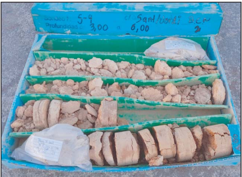
Fotografia 3. Material recuperat en el sondeig S-9 entre les cotes de -3.0 a -6.0 metres de profunditat.
