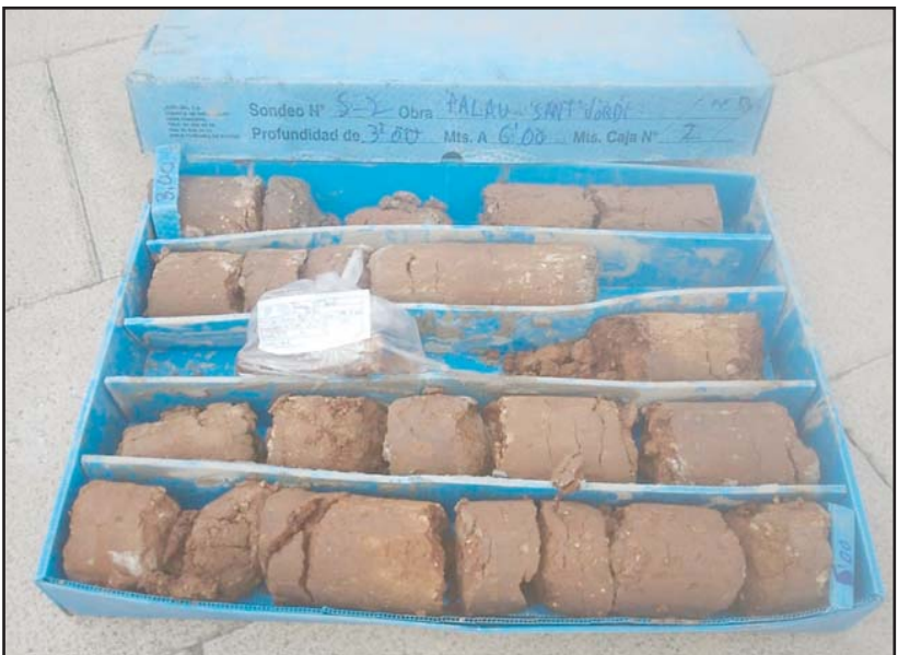
Fotografia 3. Material recuperat en el sondeig S-2 entre les cotes de -3.00 a -6.00 metres de profunditat.
