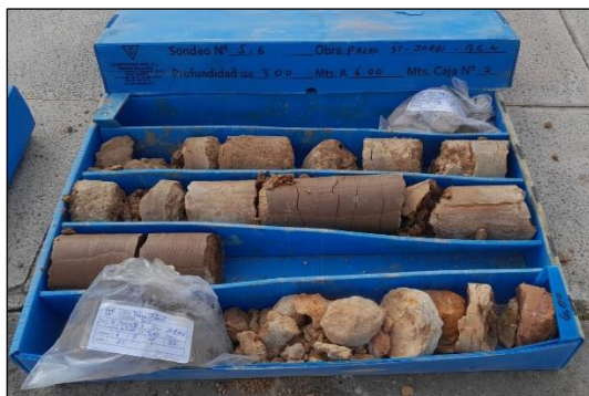
Fotografia 8 i Fotografia 9. Detall dels diferents tipus de materials del nivell 1, en dos dels sondeigs realitzats.
