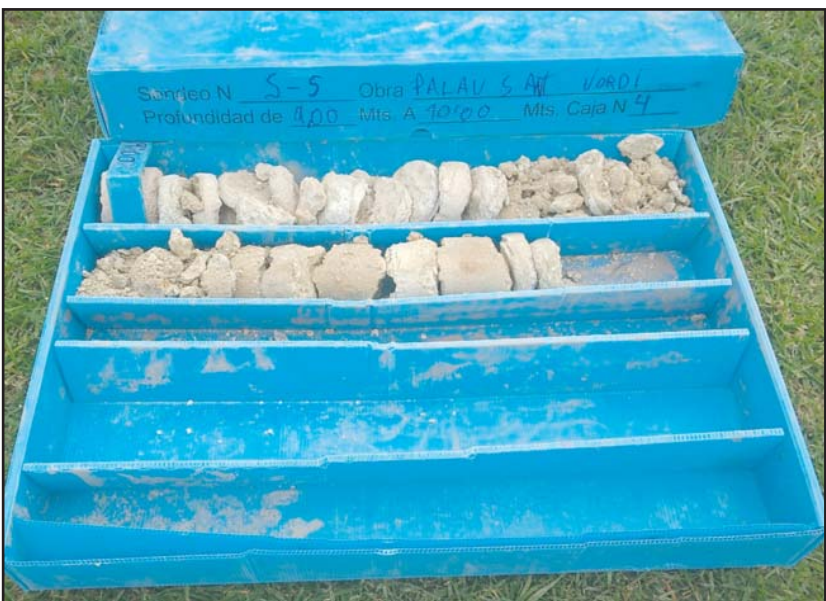
Fotografia 5. Material recuperat en el sondeig S-5 entre les cotes de -9.0 a -10.0 metres de profunditat.
