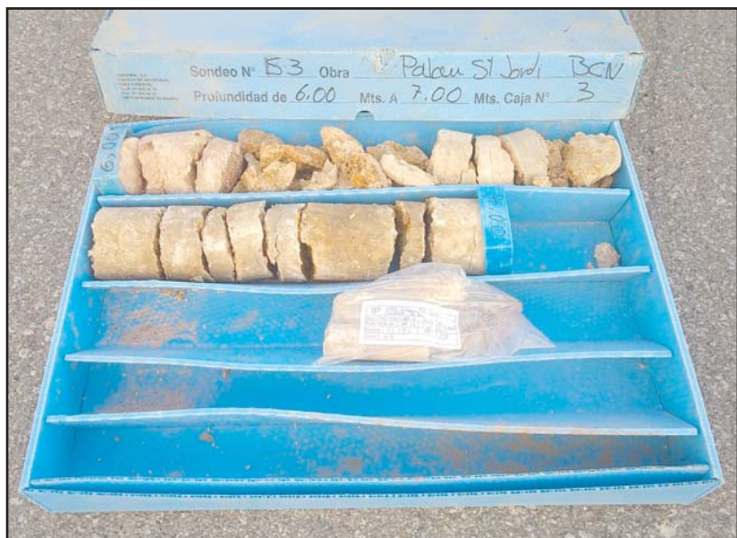
Fotografia 4. Material recuperat en el sondeig S-5 entre les cotes de -6.0 a -9.0 metres de profunditat.
