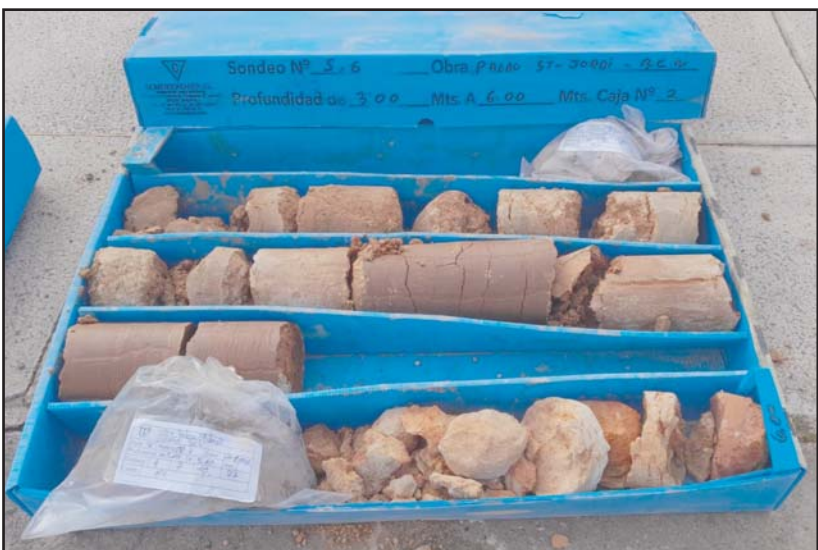
Fotografia 3. Material recuperat en el sondeig S-6 entre les cotes de -3.0 a -6.0 metres de profunditat.
