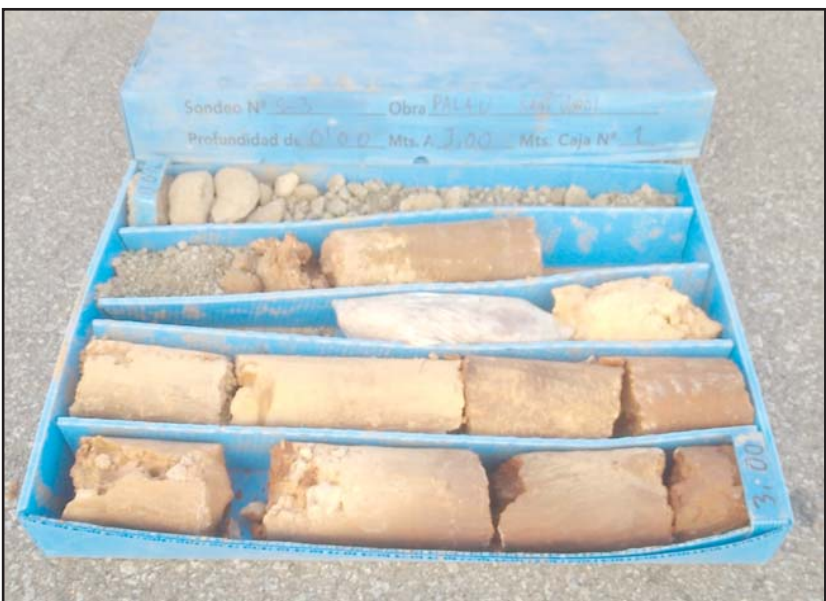
Fotografia 2. Material recuperat en el sondeig S-5 entre les cotes de 0.00 a -3.0 metres de profunditat.
