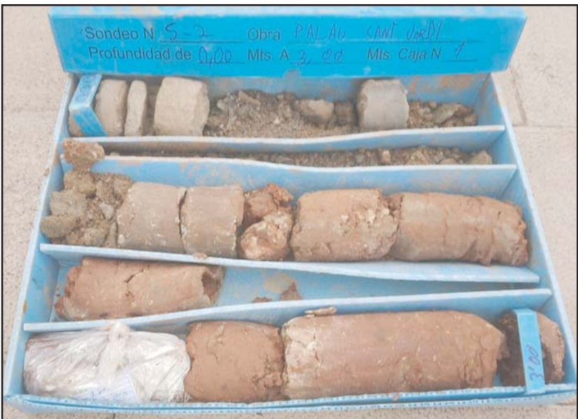
Fotografia 2. Material recuperat en el sondeig S-2 entre les cotes de 0.00 a -3.00 metres de profunditat.
