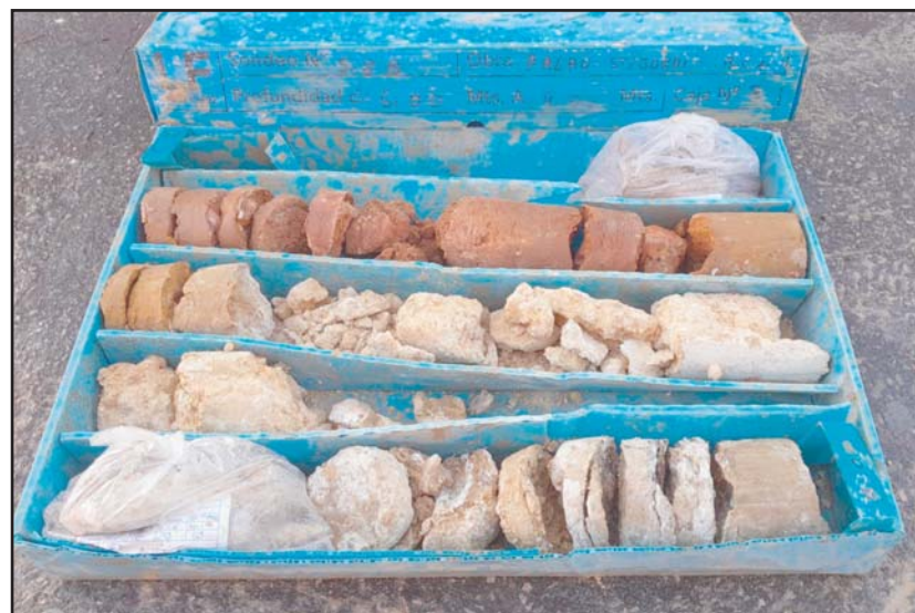
Fotografia 4. Material recuperat en el sondeig S-8 entre les cotes de -6.0 a -9.0 metres de profunditat.
