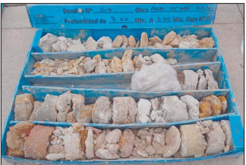
Fotografia 3. Material recuperat en el sondeig S-4 entre les cotes de -3.0 a -6.0 metres de profunditat.
