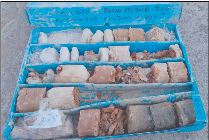
Fotografia 2. Material recuperat en el sondeig S-8 entre les cotes de 0.00 a -3.0 metres de profunditat.
