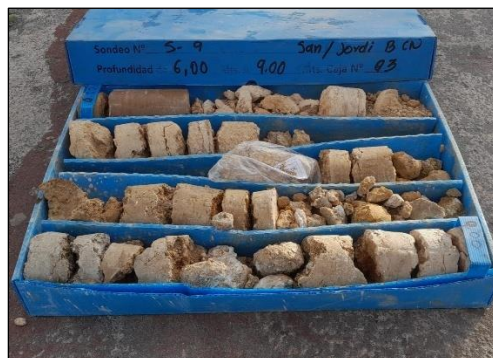
Fotografia 10 i Fotografia 11. Detall dels diferents tipus de materials del tram A del nivell 2, en dos dels sondeigs realitzats.
