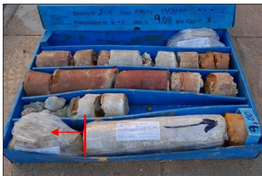
Fotografia 10 i Fotografia 11. Detall dels diferents tipus de materials del tram A del nivell 2, en dos dels sondeigs realitzats.
