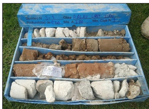
Fotografia 6 i Fotografia 7. Detall dels materials del nivell R, en diferents sondeigs realitzats.
