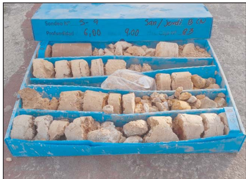
Fotografia 4. Material recuperat en el sondeig S-9 entre les cotes de -6.0 a -9.0 metres de profunditat.
