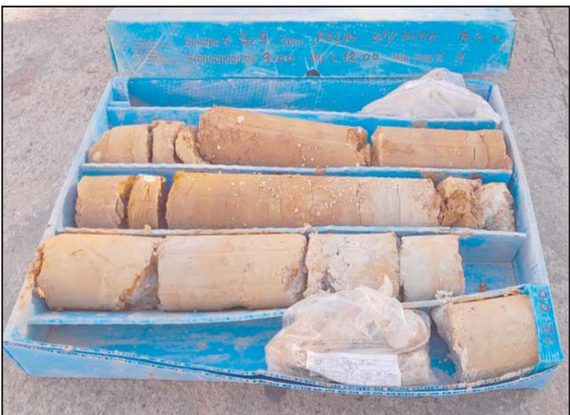
Fotografia 5. Material recuperat en el sondeig S-9 entre les cotes de -9.0 a -12.0 metres de profunditat.
