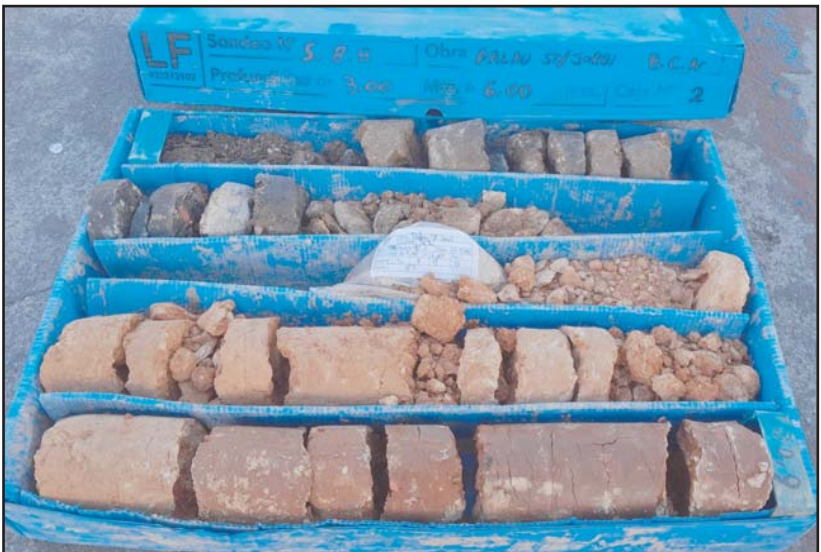
Fotografia 3. Material recuperat en el sondeig S-8 entre les cotes de -3.0 a -6.0 metres de profunditat.
