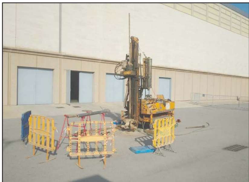
Fotografia 1. Vista de l'emplaçament de la màquina per a la realització del sondeig a rotació amb bateria continua S-5.
