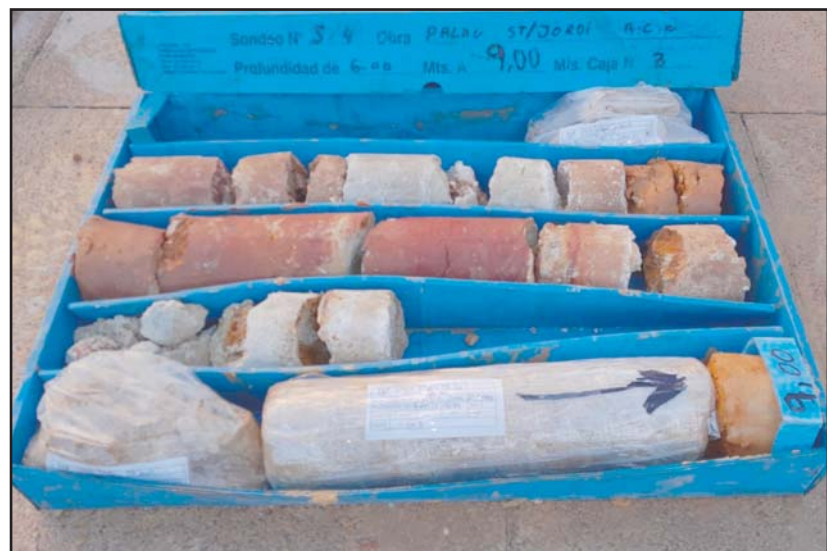
Fotografia 4. Material recuperat en el sondeig S-4 entre les cotes de -6.0 a -9.0 metres de profunditat.
