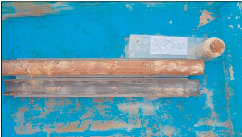
Fotografia 7. Material recuperat de l'assaig SPT-1.
