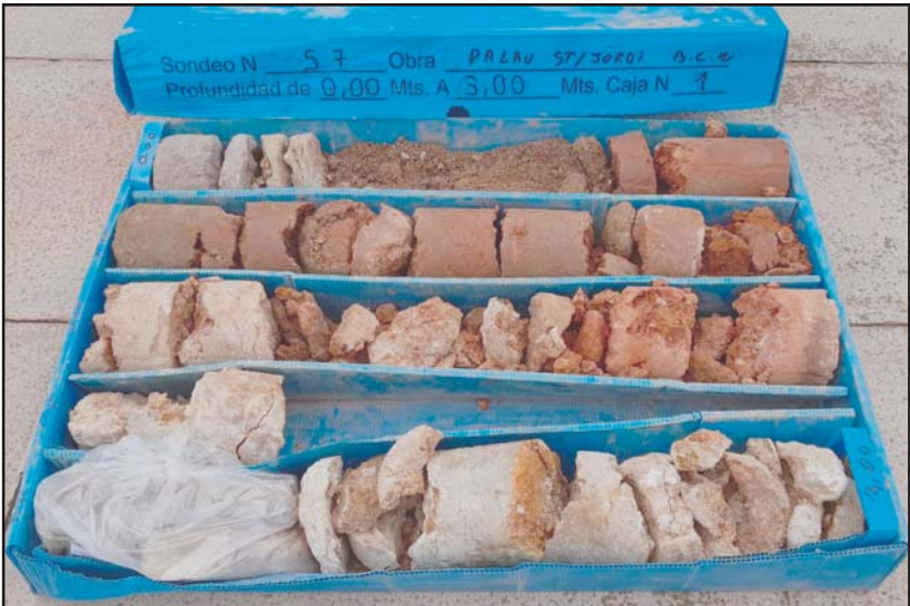
Fotografia 2. Material recuperat en el sondeig S-7 entre les cotes de 0.00 a -3.0 metres de profunditat.
