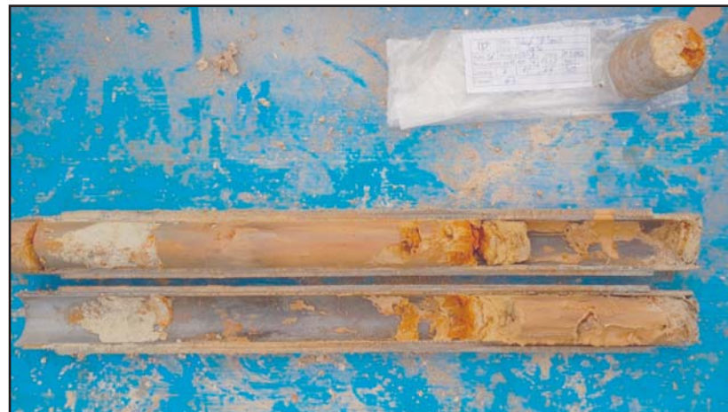
Fotografia 13. Material recuperat de l'assaig SPT-7.
